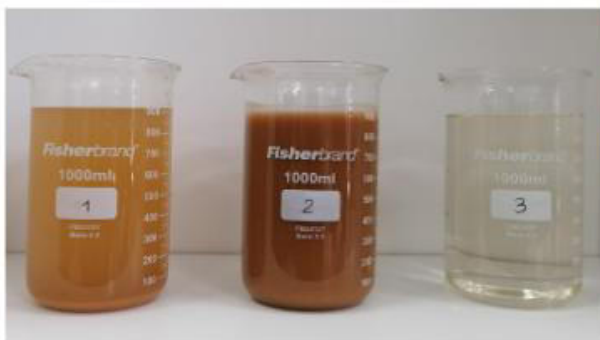
Afluente - Licor de mezcla - Efluente
