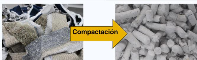
Los **residuos textiles se compactan** para llevar a cabo una mejor alimentación del proceso termoquímico, **aumentando su caudal de alimentación de 0,2 kg/h hasta 3 kg/h.** De esta forma se obtiene una mayor producción de hidrógeno por unidad de tiempo.
